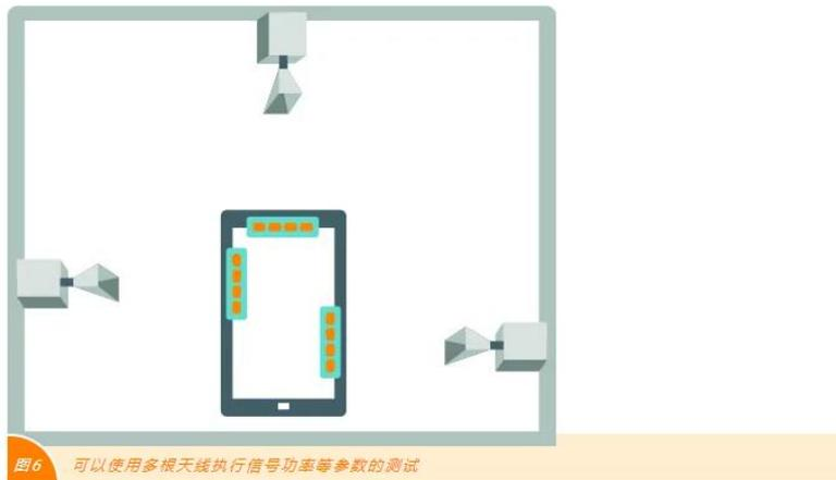
图6 可以使用多根天线执行信号功率等参数的测试
