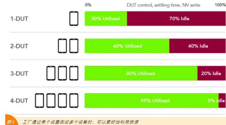
图3 工厂通过单个设置测试多个设备时，可以更好地利用资源
